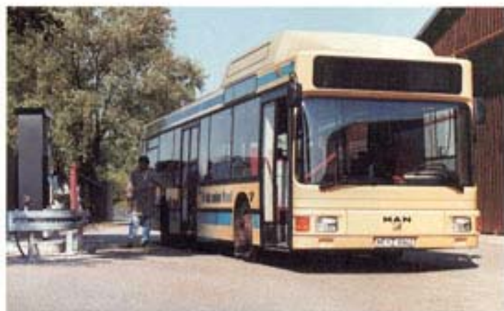
Für's Tanken wurde ein spezieller Füllstutzen entwickelt. Das „fast fill“-Verfahren ermöglicht eine vollständige Betankung in ca. 4 bis 8 Minuten – je nach Auslegung der Tankstelle.
